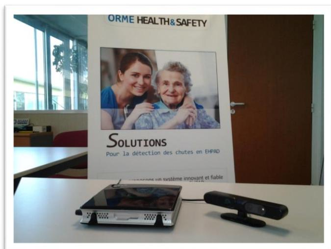
**Basé sur un capteur de profondeur, le capteur de chute d'Orme s'appuie sur des algorithmes de détection de mouvements et analyse en temps réel l'attitude de la personne.** En cas de mouvement suspect (sortie longue du lit, coucher ou lever tardif ou chute), une alerte est automatiquement envoyée à un serveur qui prévient le soignant.
